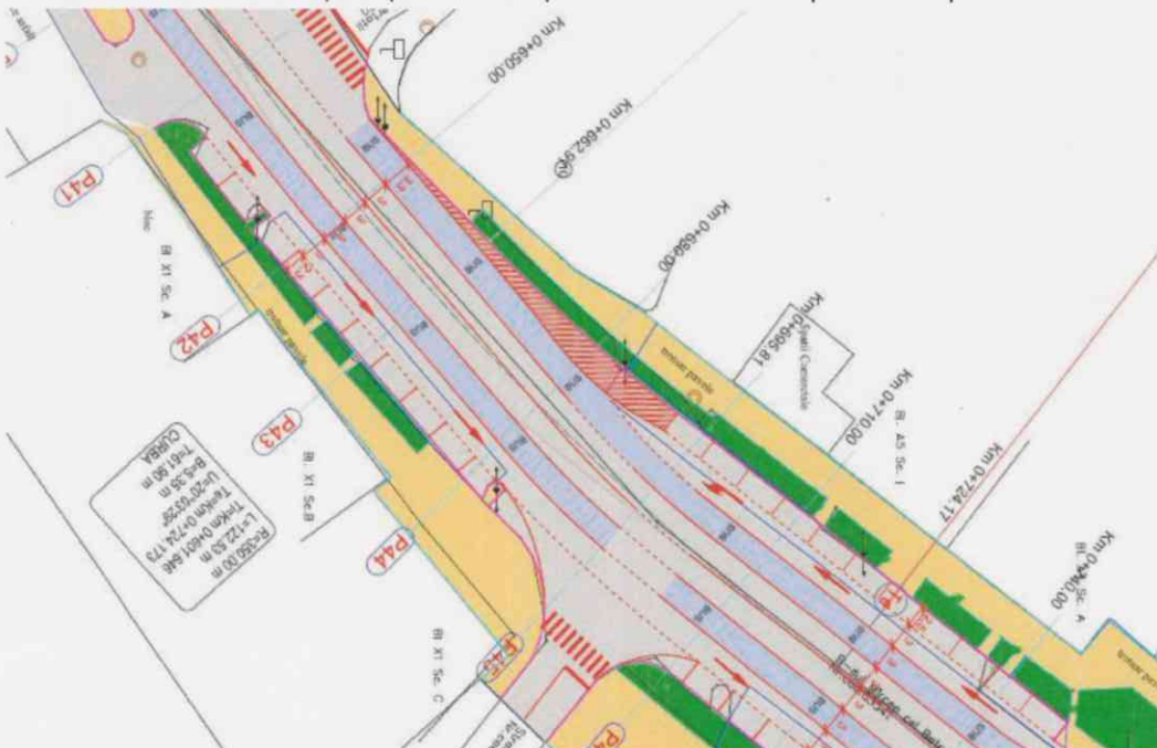
Figura 10 Exemplu locuri de parcare delimitate la marginea carosabilului în urma implementării proiectului – B-dul Mircea cel Bătrân
